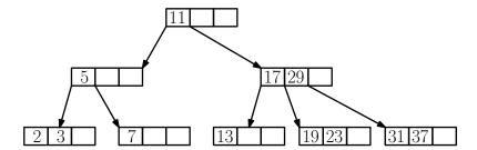
(c) Um Schlüssel 11 zu löschen, ersetzen wir ihn durch seinen symmetrischen Vorgänger 7 und löschen den symmetrischen Vorgänger im Blattknoten. Dadurch gibt es einen Unterlauf in diesem Blattknoten. Da der linke Nachbar des Blattknotens nicht minimal viele Schlüssel besitzt, rotieren wir von diesem Nachbarn in den Blattknoten mit dem Unterlauf, d.h. die 5 wird in den Blattknoten rotiert und die 3 aus dem Nachbarknoten wird an die alte Stelle der 5 rotiert.
